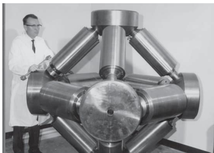
Рис 1.13. Конструкції АВТ, розроблених Т. Холлом: тетрадричний (а) і шестипуансонний кубічний (б).
