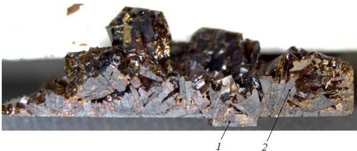
Рис. 5.4. Витравлений з розчин-розплавної системи полікристалічний прошарок GaN, отриманий із експерименту за \text{grad}T = 8,2 °C/мм: 1 – зародковий кристал GaN, 2 – полікристалічний прошарок GaN.
