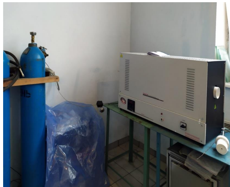
Піч СУОЛ-15/1300 яка оснащена багатоступеневим цифровим програмним модулем з робочою температурою до 1300 °С та можливістю проводити спікання як на повітрі, так і в атмосфері різних газів (кисень, азот, аргон тощо)
