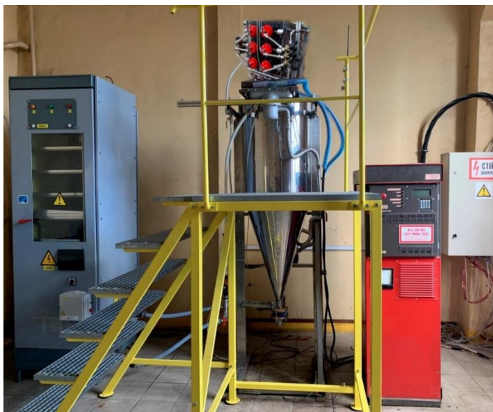
Установка електроерозійного диспергування для виготовлення нанопорошків та порошків мікронного розміру і сушильна шафа для порошків.
