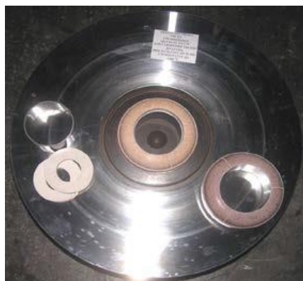
АВТ “ковадла з заглибленнями” \varnothing 9-62 \times 5-25 мм
