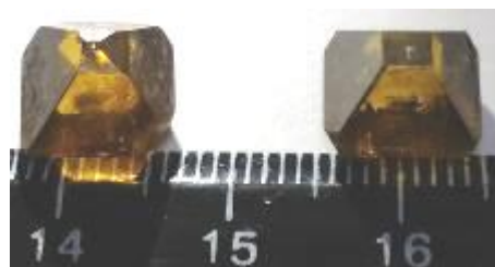
НРНТ-монокристали алмазу Ib та IIa типу, одержані за 1 цикл вирощування.
