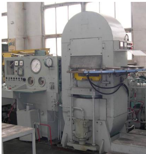
Прес зусиллям 25 МН для пресування до p = 8 ГПа, T = 1800 °С
