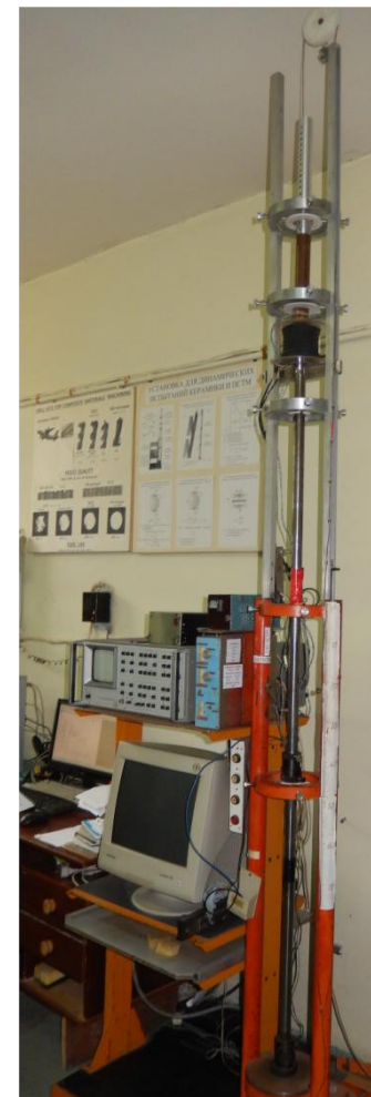
Машини оцінки границі міцності під час розтягування, згинання, стискання. Копір з мірними стержнями Гопкинса
