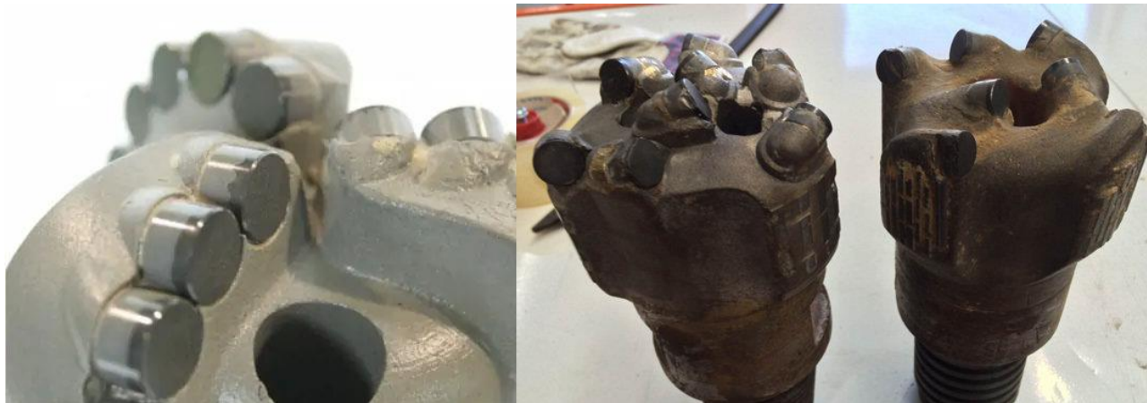
Рисунок 1.10. Приклади вигляду бурових PCD доліт.
