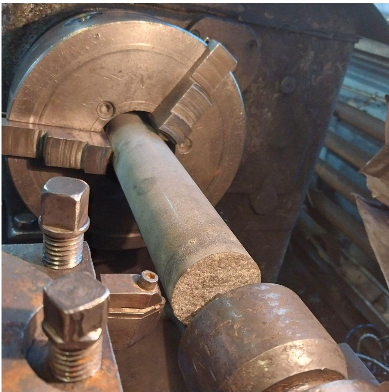
Рисунок 2.10. Випробування зносостійкості на верстаті 1К62
