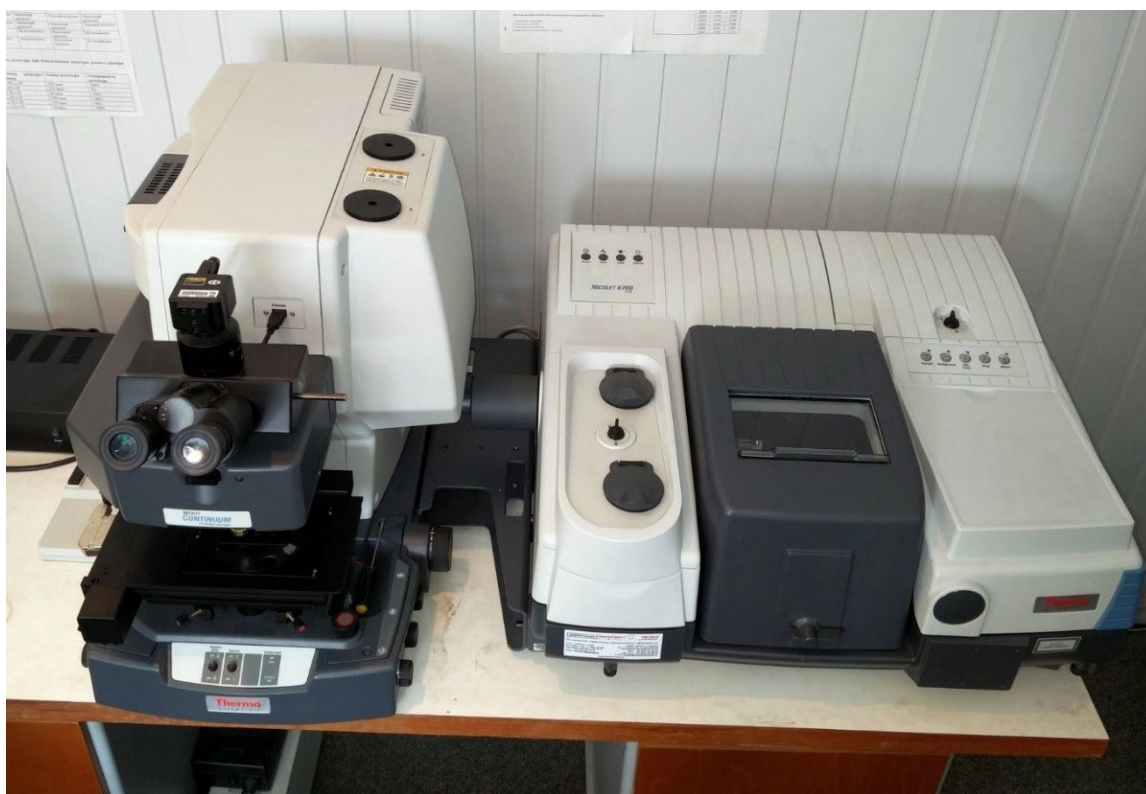
Рисунок 2.11 – Зовнішній вигляд ІЧ – Фур'є спектрометра Nicolet 6700 та ІЧ – мікроскопа Nicolet Continuum [85]
