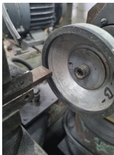
Рисунок 6.1. Шліфування загартованої сталі кругом із бурштинового КНБ.
